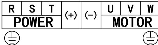
图 4-7 主回路接线端子图(18 款 55~160kW)
