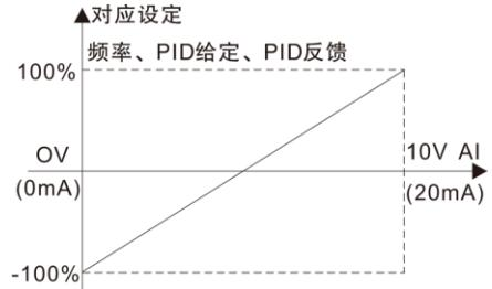
图 6-13 模拟给定与设定量的对应关系
