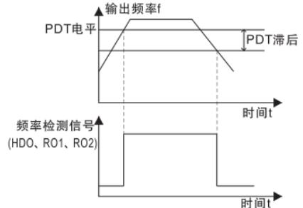
图 6-16 FDT 电平示意图
