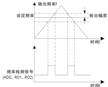
图 6-17 频率到达检出幅值示意图
