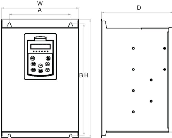
图 A-5 132kW 及以下机型外形尺寸 (660V)
