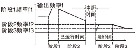
图 6-24 简易 PLC 启动方式 1
