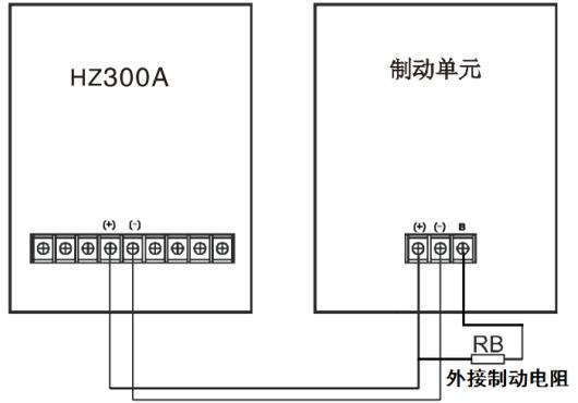
图 B-2 制动单元的连接
