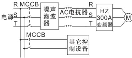
图 4-22 主回路电源侧连接图
