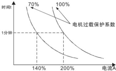
图 6-25 电机过载保护系数设定
