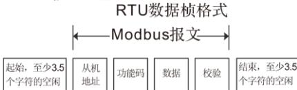
一个帧的信息必须以连续的数据流进行传输，如果整个帧传输结束前有超过 1.5 个字节以上的间隔时间，接收设备将清除这些不完整的信息，并错误认为随后一个字节是新一帧的地址域部分，同样的，如果一个新帧的开始与前一个帧的间隔时间小于 3.5 个字节时间，接收设备将认为它是前一帧的继续，由于帧的错乱，最终 CRC 校验值不正确，导致通讯故障。
