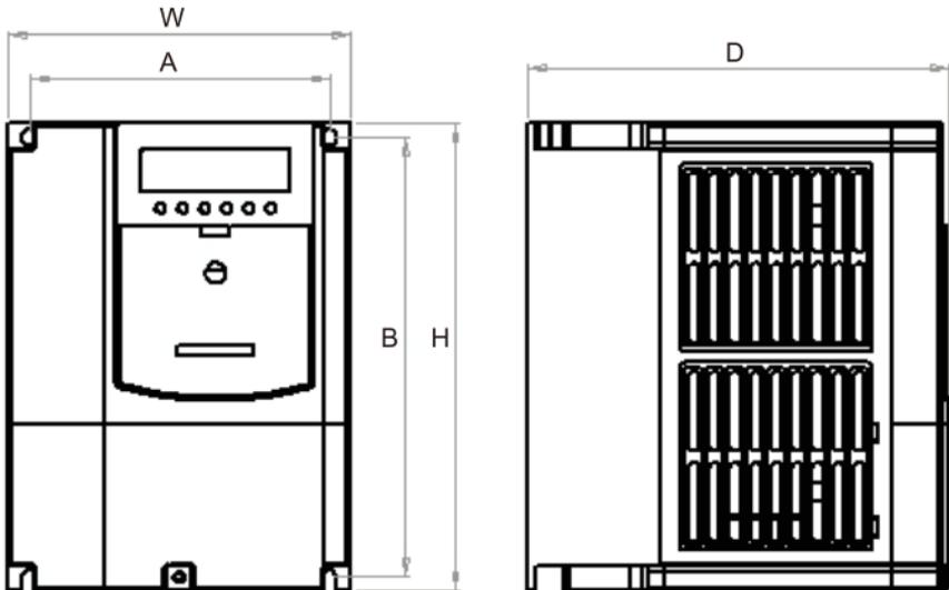
图 A-4 0.75~5.5KW 机型的外形尺寸图 (220V)
