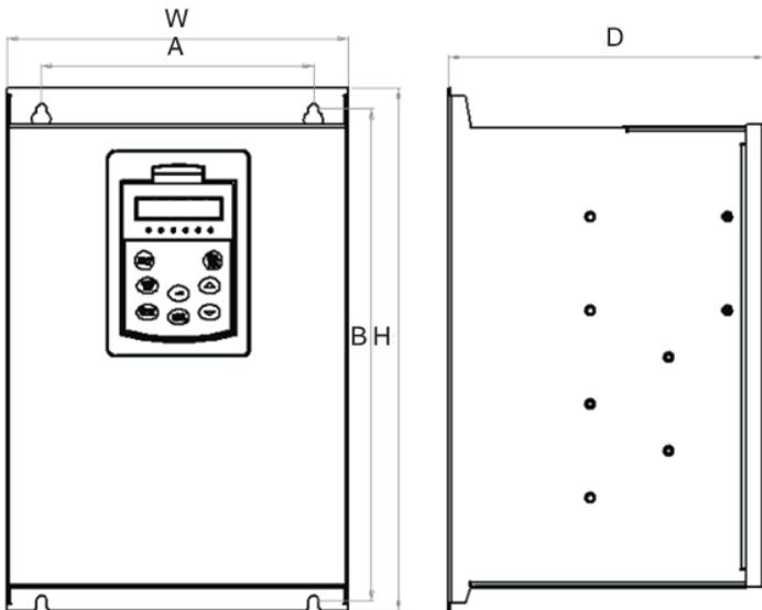
图 A-2 11~110kW 机型外形尺寸 (380V)
