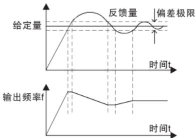
图 6-21 偏差极限与输出频率的对应关系
