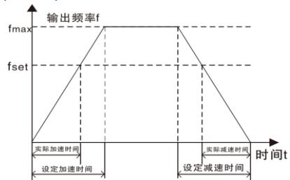
图 6-1 加减速时间示意图
