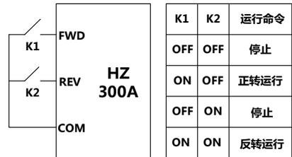
图 6-10 两线式控制（使能与方向分离）
