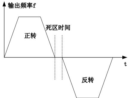
图 6-4 正反转死区时间示意图
