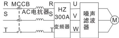
图 4-23 主回路电机侧连接图
