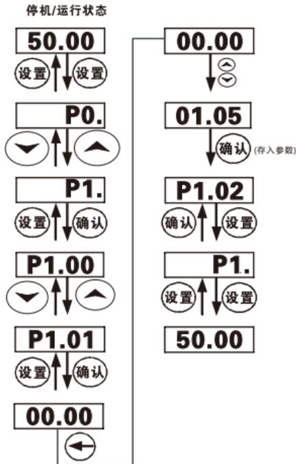
图 5-2 三级菜单操作流程图
