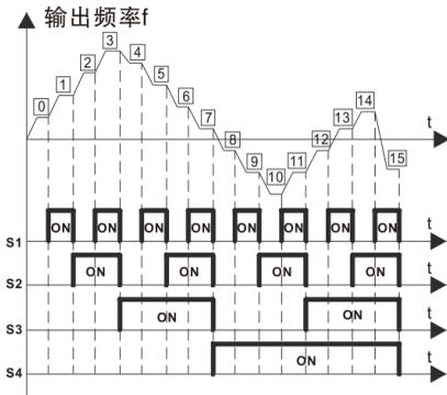
图6-23 多段速度运行逻辑图
