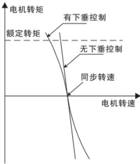
图 6-19 下垂控制电机特性示意图
