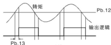
图 6-28 过转矩控制示意图
