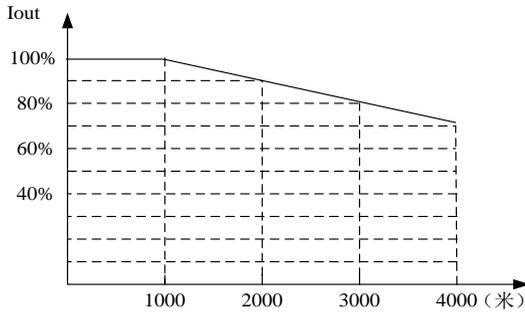
图 3-1 安装地点的海拔高度
