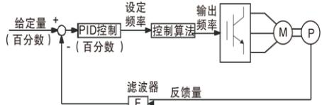
图 6-20 过程 PID 原理框图
