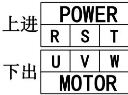
图 4-13 主回路接线端子图(18.5~45kW)
