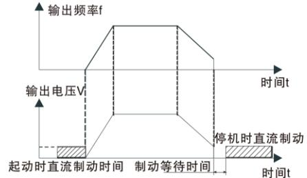
图 6-3 直流制动示意图
