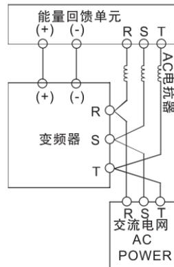
图 4-24 能量回馈单元连接图
