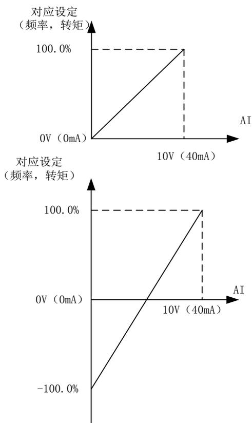
图 7-10 模拟给定与设定量的对应关系
