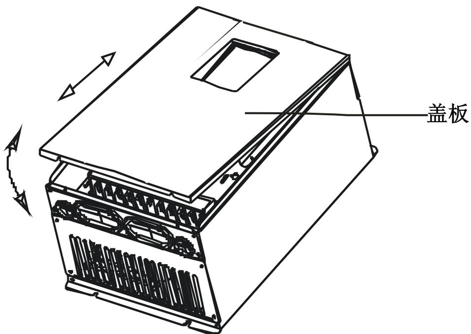
钣金盖板的拆卸和安装示意图
