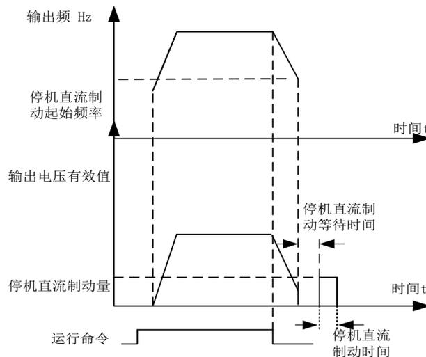
图 7-13 停机直流制动示意图
