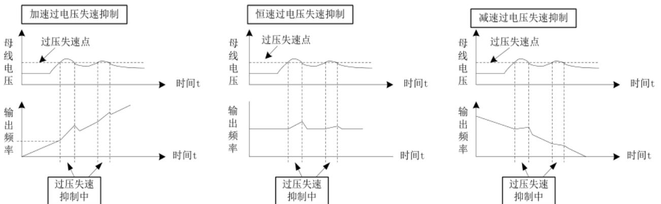
图 7-11 过压失速动作示意图
