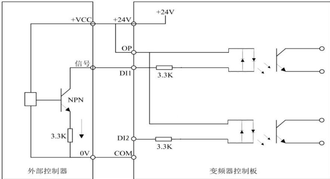
图 4-3 数字输入端子漏型接线图
