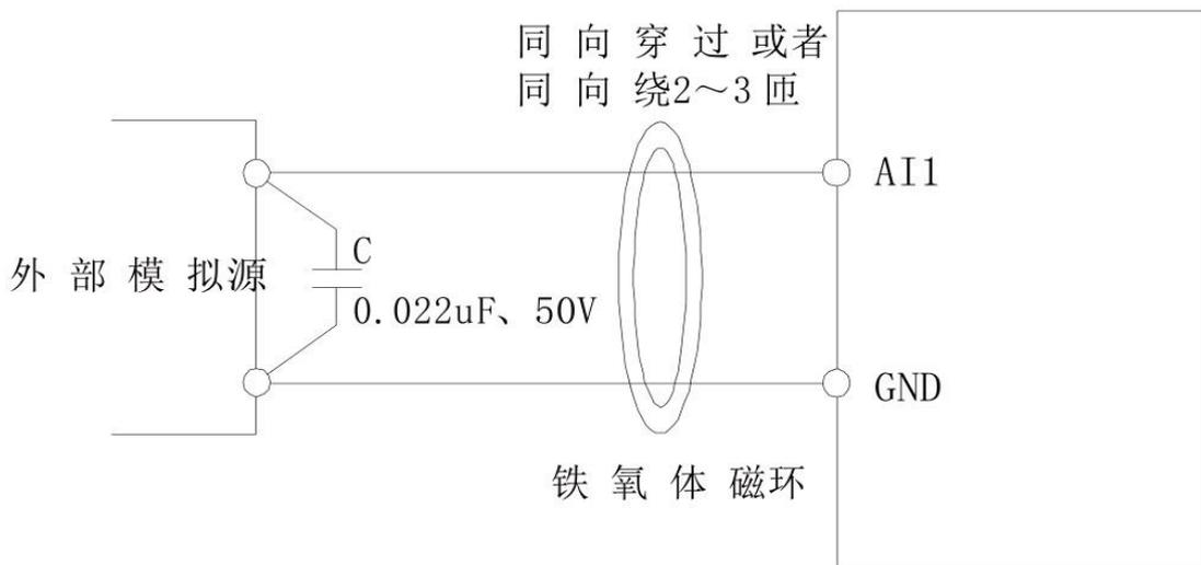
图 4-2 模拟量输入端子处理接线图
