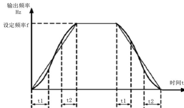
图 7-11 S 曲线加减速 A 示意图
