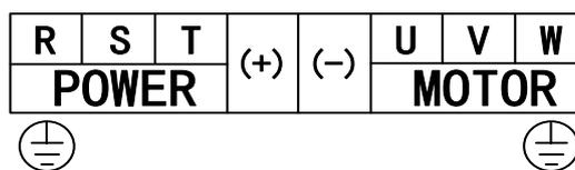
主回路接线端子图(55 ~ 160kW)
