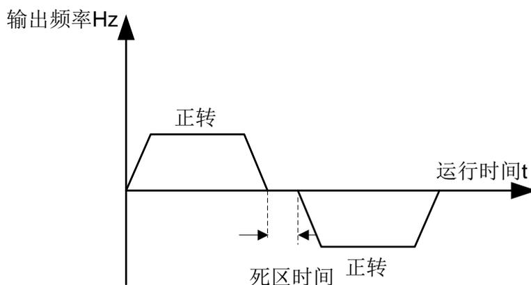
图 7-15 正反转死区时间示意图
