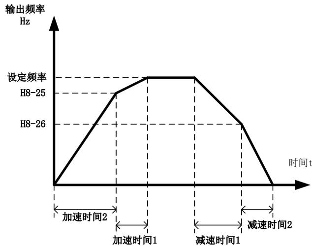
图 7-19 加减速时间切换示意图
