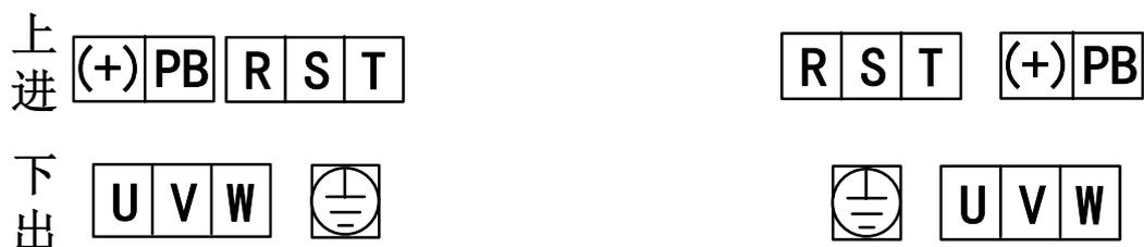
主回路接线端子图(11 ~ 22kW)
