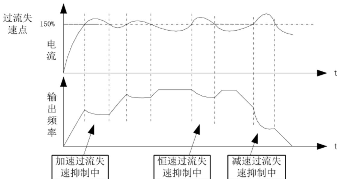
图 7-9 过流失速动作示意图
