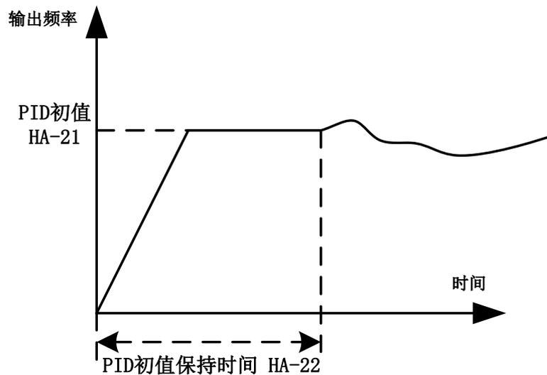
图 7-27 PID 初值功能示意图
