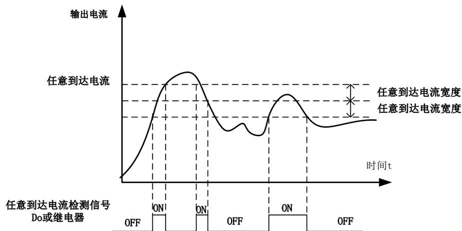
图 7-23 任意到达电流检测示意图
