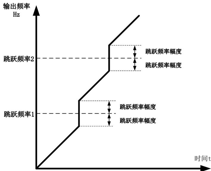
图 7-18 加减速过程中跳跃频率有效示意图
