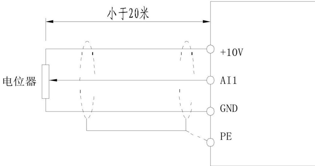
图 4-1 模拟量输入接线示意图
