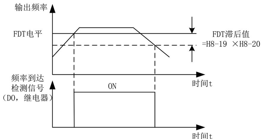
图 7-16 FDT 电平示意图
