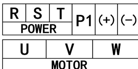
主回路接线端子图(160 ~ 400kW)
