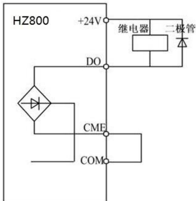
图 4-5 数字输出端子接线示意图
