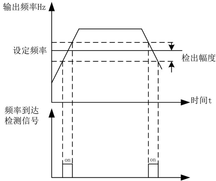
图 7-17 频率到达检出幅值示意图
