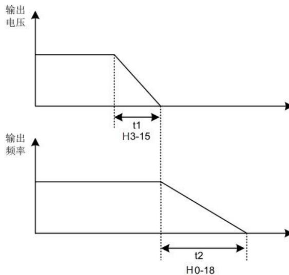
图 7-8 V/F 分离频率 / 电压先后下降示意图
