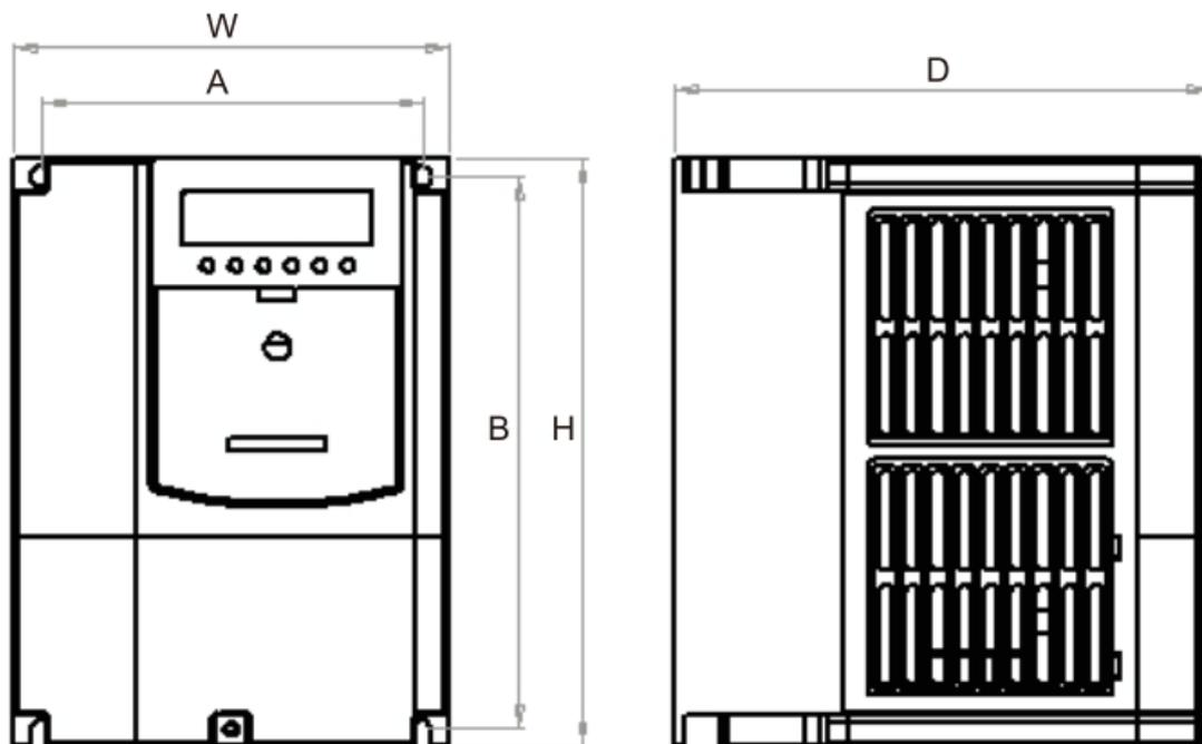
0.75 ~ 5.5KW 机型的外形尺寸图 ( 220V )
