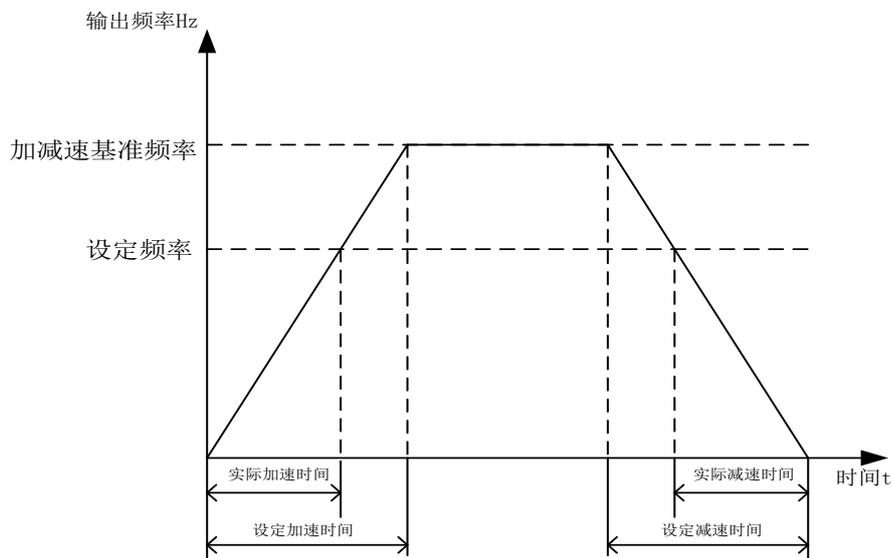
HZ800 提供 4 组加减速时间，用户可利用数字量输入端子 DI 切换选择，四组加减速时间可通过如下功能码进行设置：
