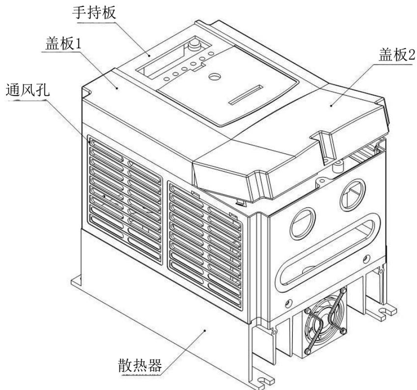
塑胶盖板的安装与拆卸示意图
