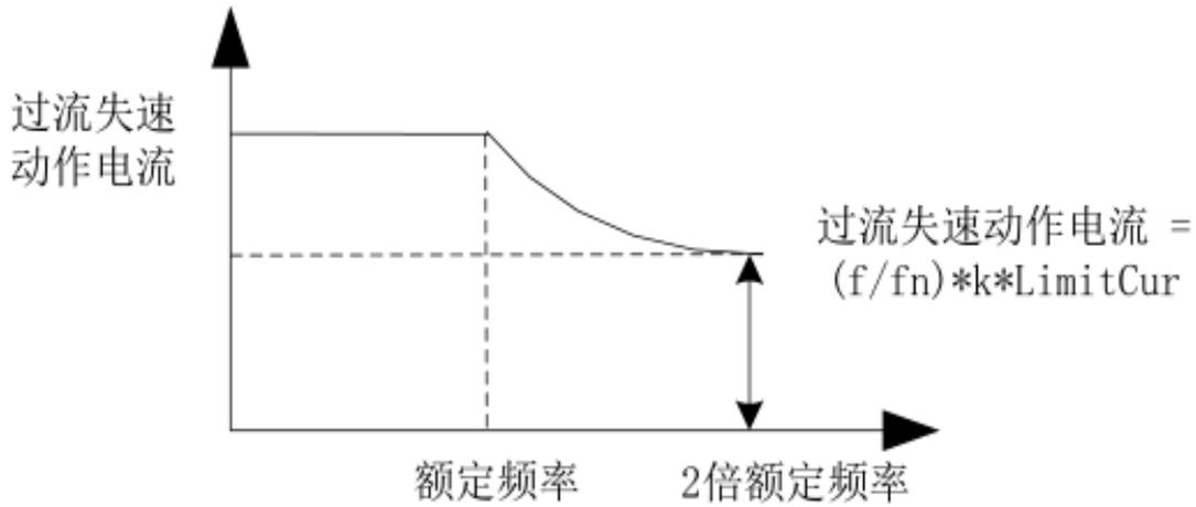
图 7-10 倍速过流失速动作示意图
