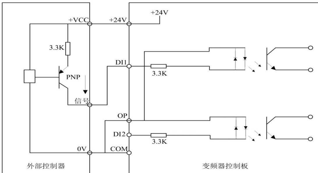
图 4-4 数字输入端子源型接线图
