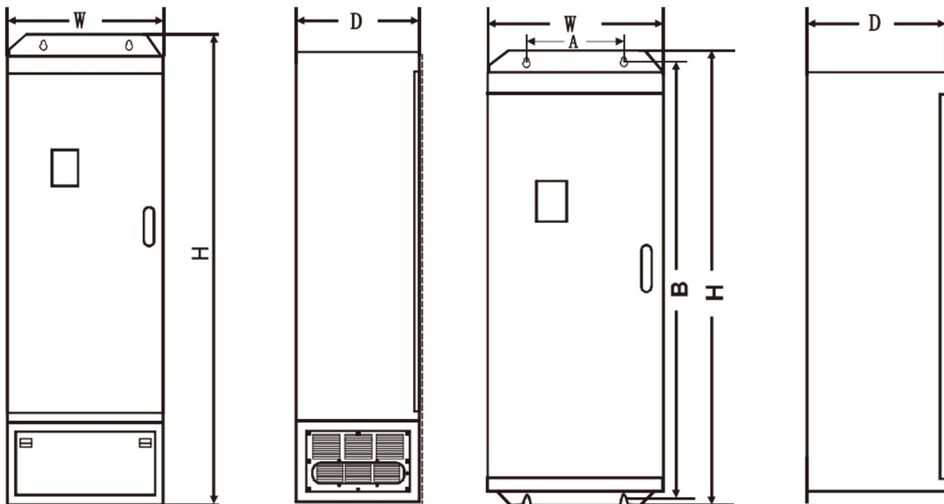
132 ~ 630KW 机型 ( 柜机和挂机 ) 的外形尺寸 ( 380V )
