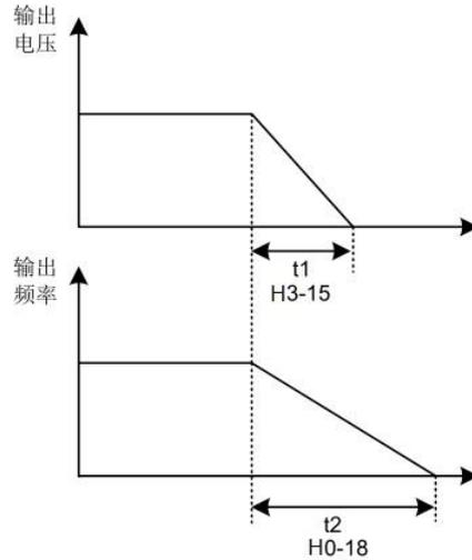
图 7-6 V/F 分离输出电压 / 频率独立减至 0
