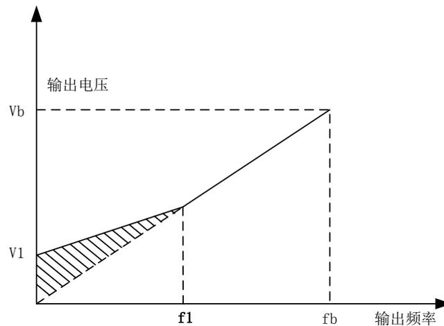
V1: 手动转矩提升电压      Vb: 最大输出电压
